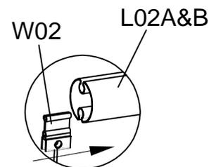
Stecken Sie das Teil W02 in die L02A&B an beiden Enden der Sonnenschutzstange. Bringen Sie dann den Seil- und Federspanner W03 an, um das Schattentuch fest zu fixieren.
