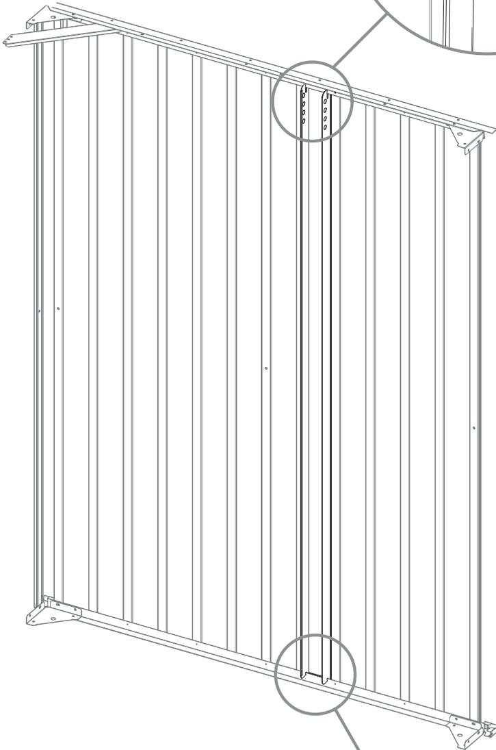
Bitte stellen Sie sicher, dass die Seite mit dem längsten Einsteckschlitz nach oben zeigt und die offene Seite des Profils von Ihnen weg zeigt.
