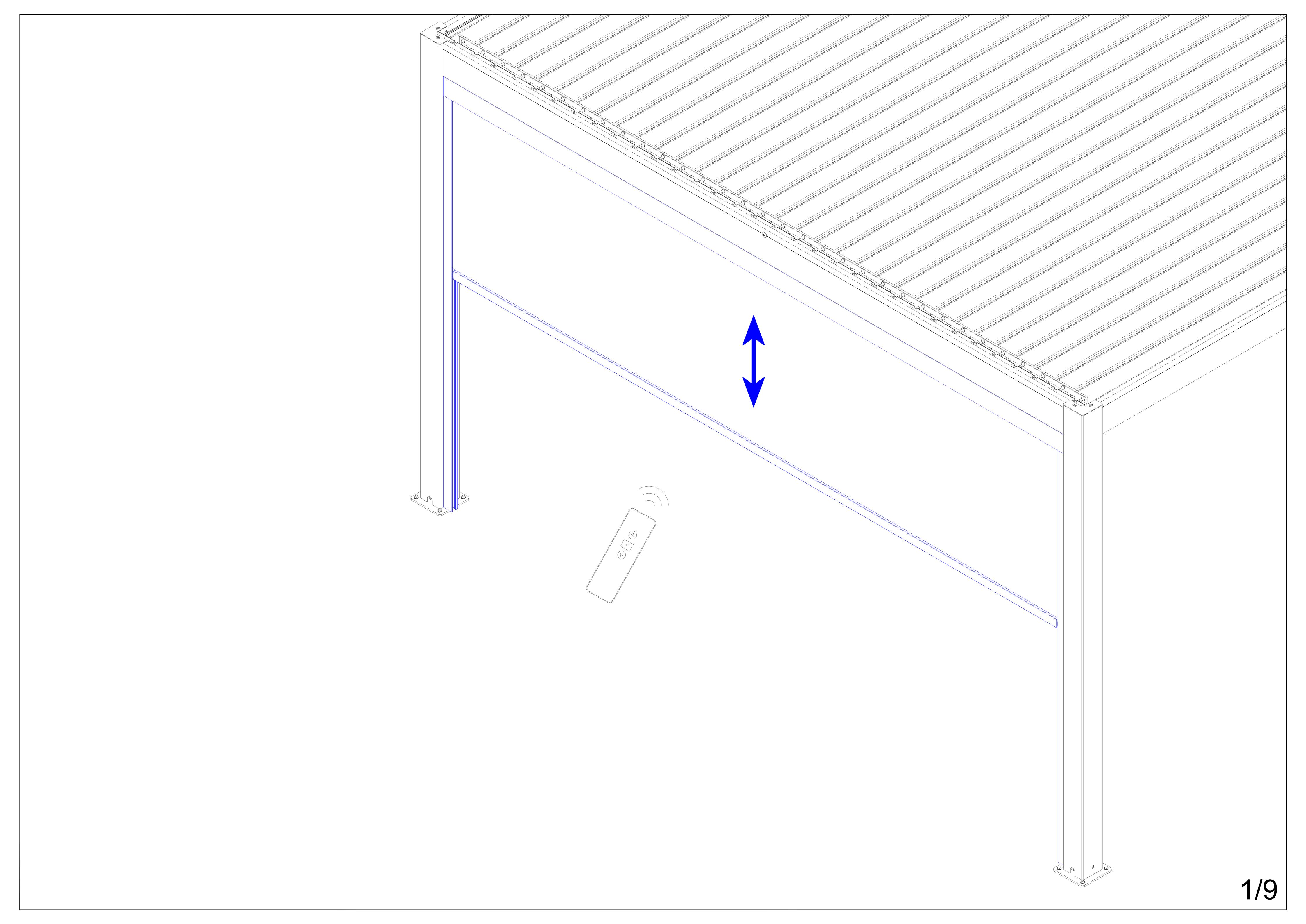
1. Wie gezeigt, muss die Breite zwischen zwei Pfosten und der Diagonale gemessen und nivelliert werden. Damit soll sichergestellt werden, dass die Innenmaßen für den Einbau der motorisierten Seitenwand korrekt sind.
