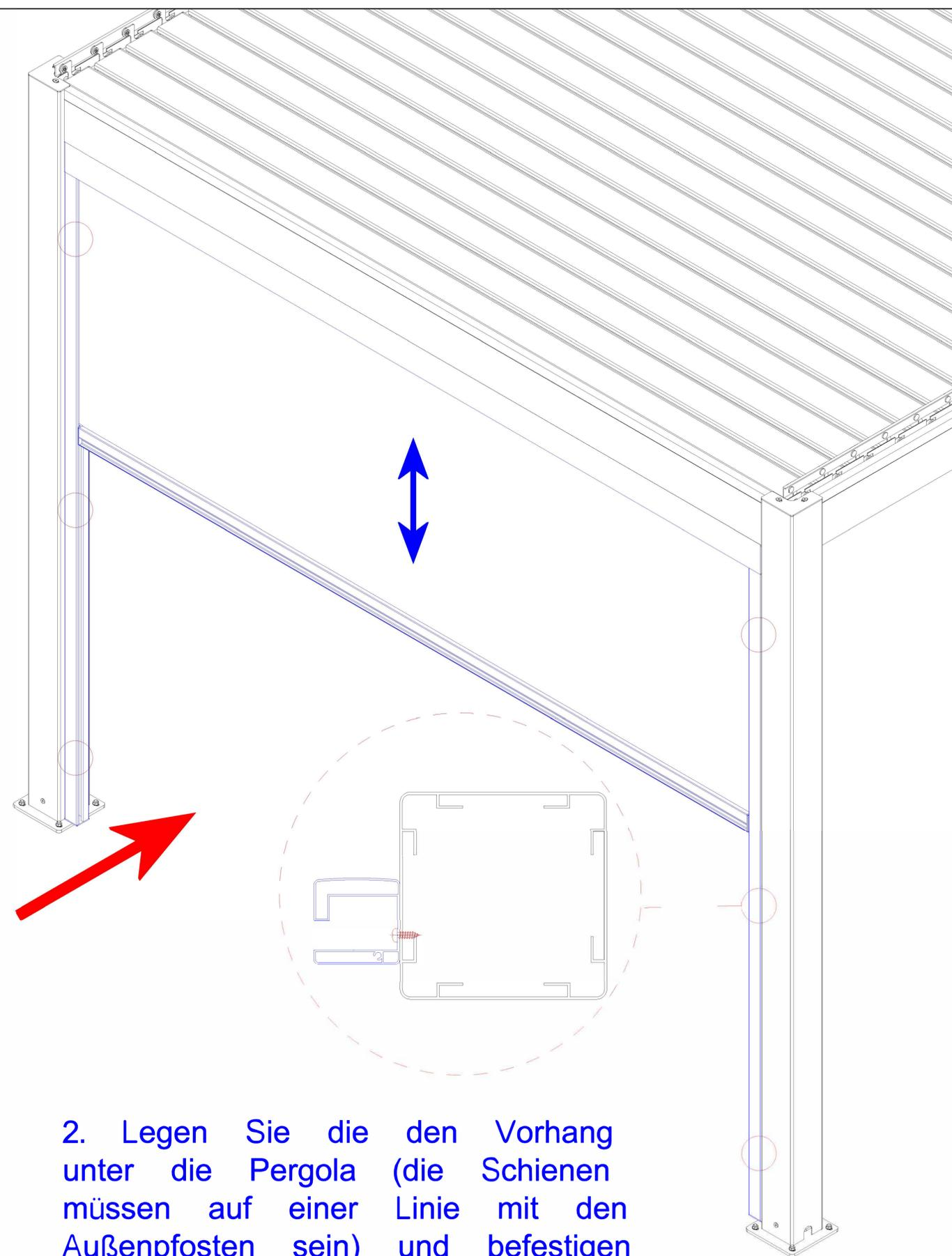
2. Legen Sie die den Vorhang unter die Pergola (die Schienen müssen auf einer Linie mit den Außenposten sein) und befestigen Sie danach jede Schiene mit 3 Schrauben, um die Montage abzuschließen.
