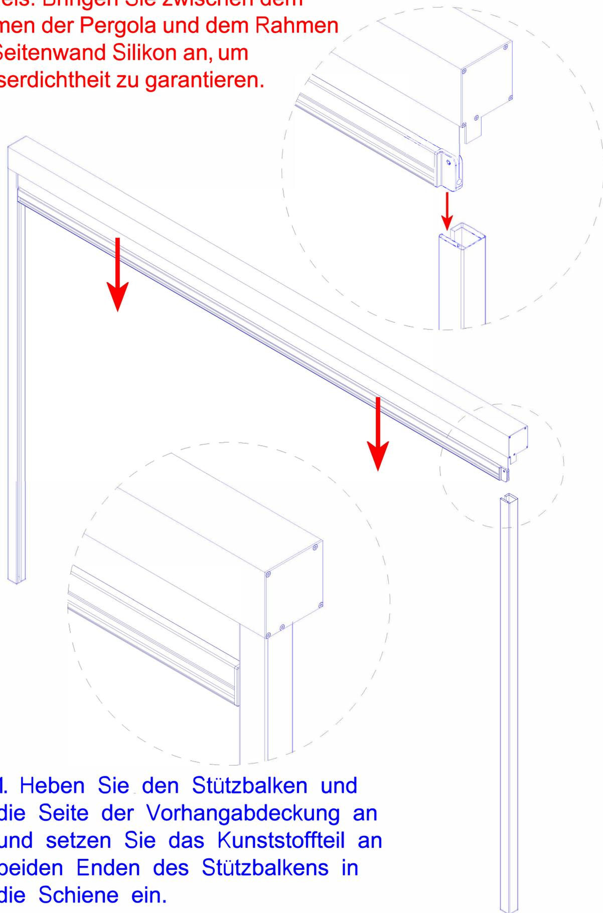
1. Heben Sie den Stützbalken und die Seite der Vorhangabdeckung an und setzen Sie das Kunststoffteil an beiden Enden des Stützbalkens in die Schiene ein.
