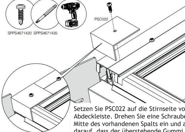
Setzen Sie PSC022 auf die Stirnseite von jeder Abdeckleiste. Drehen Sie eine Schraube in die Mitte des vorhandenen Spalts ein und achten Sie darauf, dass der überstehende Gummi ordnungsgemäß nach unten klappt.
