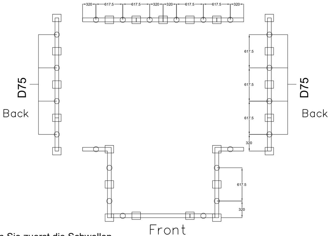
Legen Sie zuerst die Schwellen, Verbinder und Ankerwinkel ungefähr an Ort und Stelle aus. Ziehen Sie sie dann mit den mitgelieferten Schrauben und Muttern fest.
