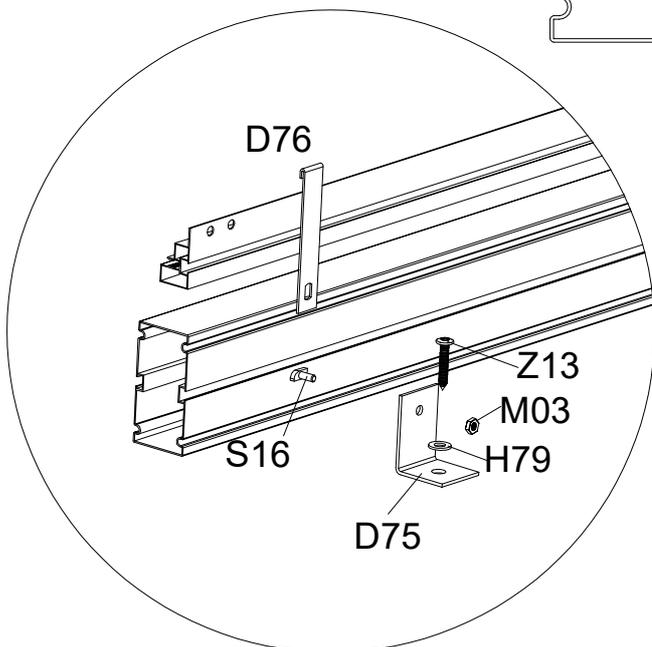
Dies zeigt ein Layout für die Positionen von D75 und D76, wo es in der Mitte des PC-Panels für jeden Abschnitt platziert wird.
