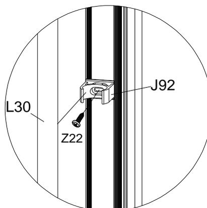
Bohren Sie ein Loch in L01A und L01B mit einem Ø von 3mm und 700mm von unten. Befestigen Sie die J92-Halterung mit Z22-Schrauben und klemmen Sie dann das L30-Fallrohr in die J92-Halterung.
