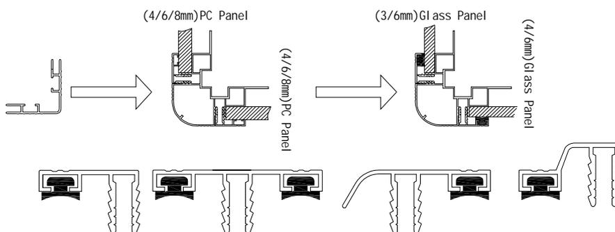
\* Wenn das Gewächshaus mit Glaspaneelen ausgestattet ist, sollte jede Abdeckleiste mit dem mitgelieferten Gummi versehen werden. Schieben Sie ihn einfach in die Abdeckleisten.
