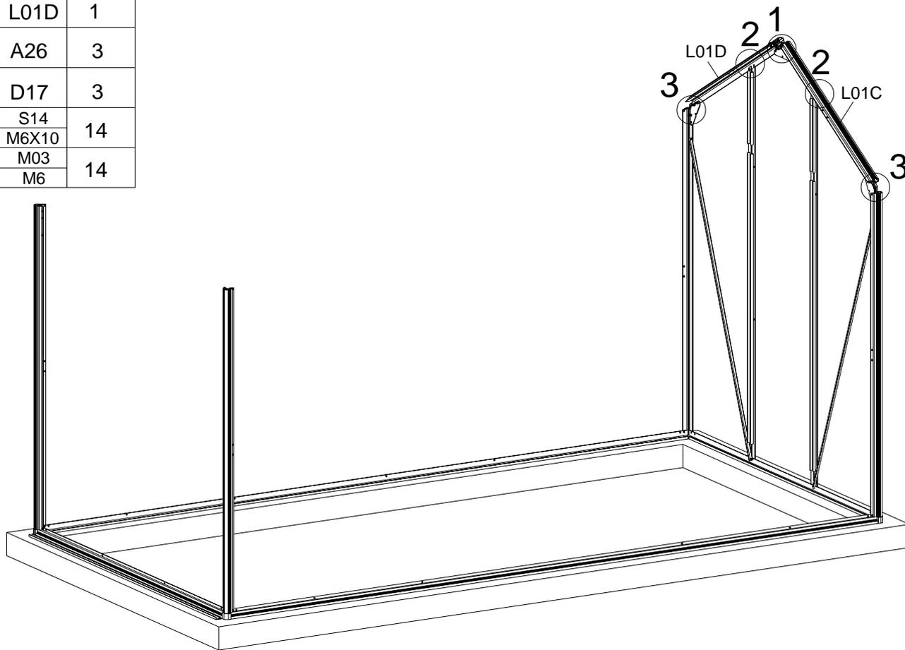
Schieben Sie den Verbinder A26 in L01C und L01D um sie zu verbinden. Verwenden Sie Teil D17 um alles mit den mitgelieferten Schrauben und Muttern zu befestigen.
