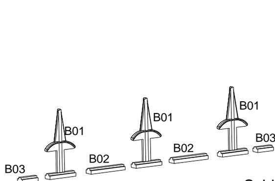
Schieben Sie B01, B02 und B03 in der richtigen Reihenfolge in jede Seite von L26. Verwenden Sie ggf. einen Gummihammer.
