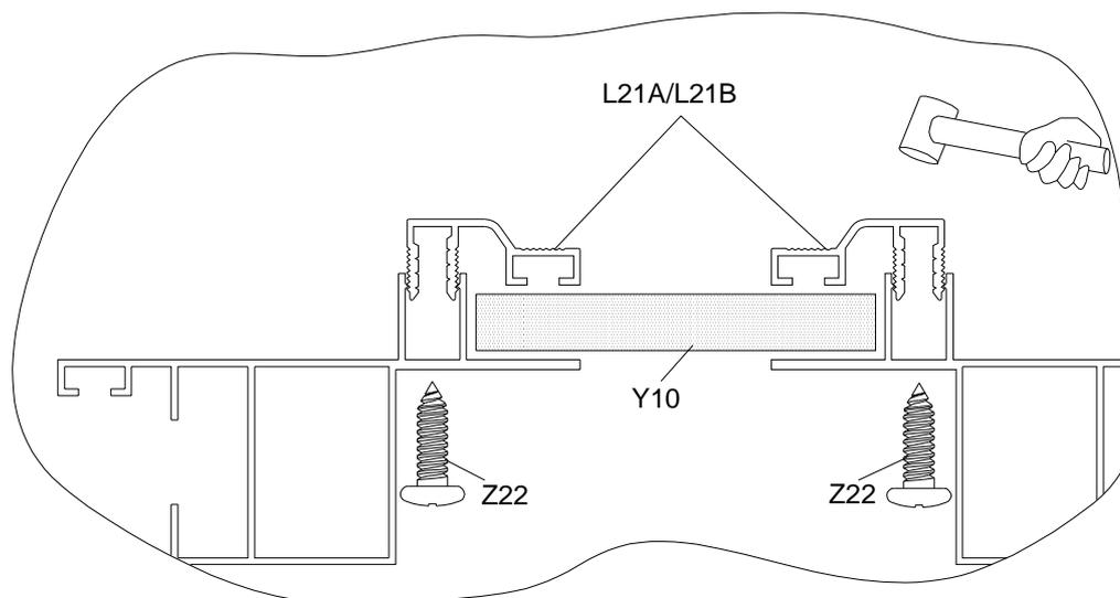
Die PC-/Glasplatte Y10 wird von den Abdeckleiste, den Profilen L121 A und B, locker gehalten (bei Glas in die Profile Gummi einlegen!). Setzen Sie die Abdeckleiste mit dem Gummihammer vorsichtig in die richtige Position. Befestigen Sie dann die Abdeckleiste mit den Schrauben Z22.
