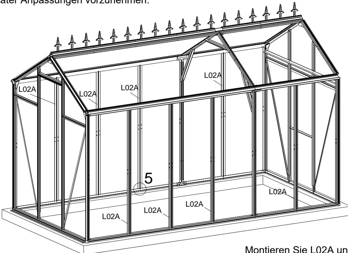
Montieren Sie L02A und achten Sie darauf, dass 2 zusätzliche Schrauben lose in das Profil eingeführt werden, die später zur Befestigung der Verstärkung benötigt werden.
