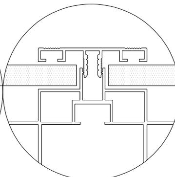
Schieben Sie alle Y6-Platten an ihren Platz. Die Oberseite der Platten sollte hinter das Rinnenprofil geschoben und dann gegen das Basisprofil gedrückt werden, wie in den Detailzeichnungen gezeigt. Die Platten sollten durch die Abdeckleisten L11A, L11C und L12A locker gehalten werden. Klopfen Sie die Abdeckleisten mit dem Gummihammer fest, aber sanft an ihren Platz.
