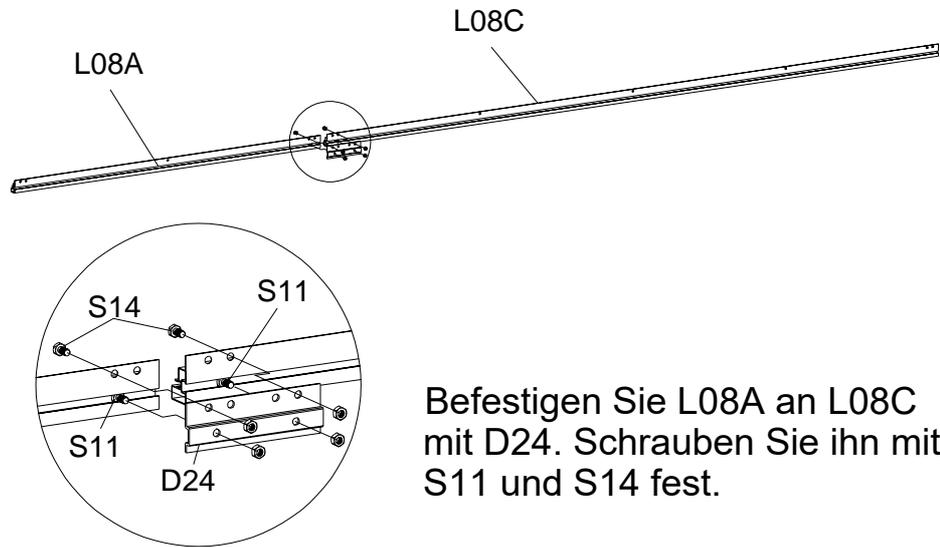
Befestigen Sie L08A an L08C mit D24. Schrauben Sie ihn mit S11 und S14 fest.
