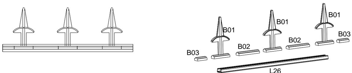
**Achtung!** Der Rahmen muss vor dem Einbau der Glas- oder Polycarbonatplatten vollständig montiert sein.
