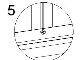
\* Vergewissern Sie sich auch, dass die Dachkantenprofile von Ende zu Ende gerade sind, bevor Sie die L22Cs an die Seiten schrauben. Sie können diese auch abschrauben um später Anpassungen vorzunehmen.
