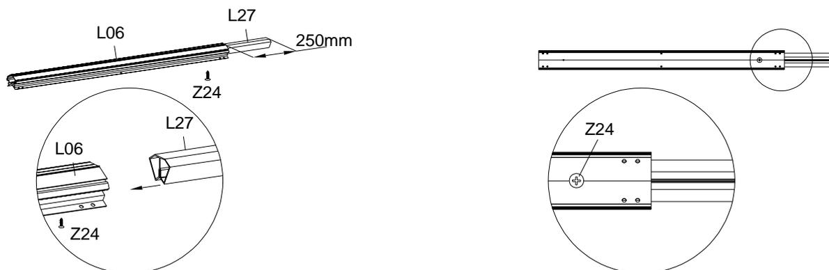
Führen Sie die Hälfte von L27 in L06 ein, so dass 250mm von L27 übrig bleiben. Sichern Sie dann L27 und L06 mit Z05.
