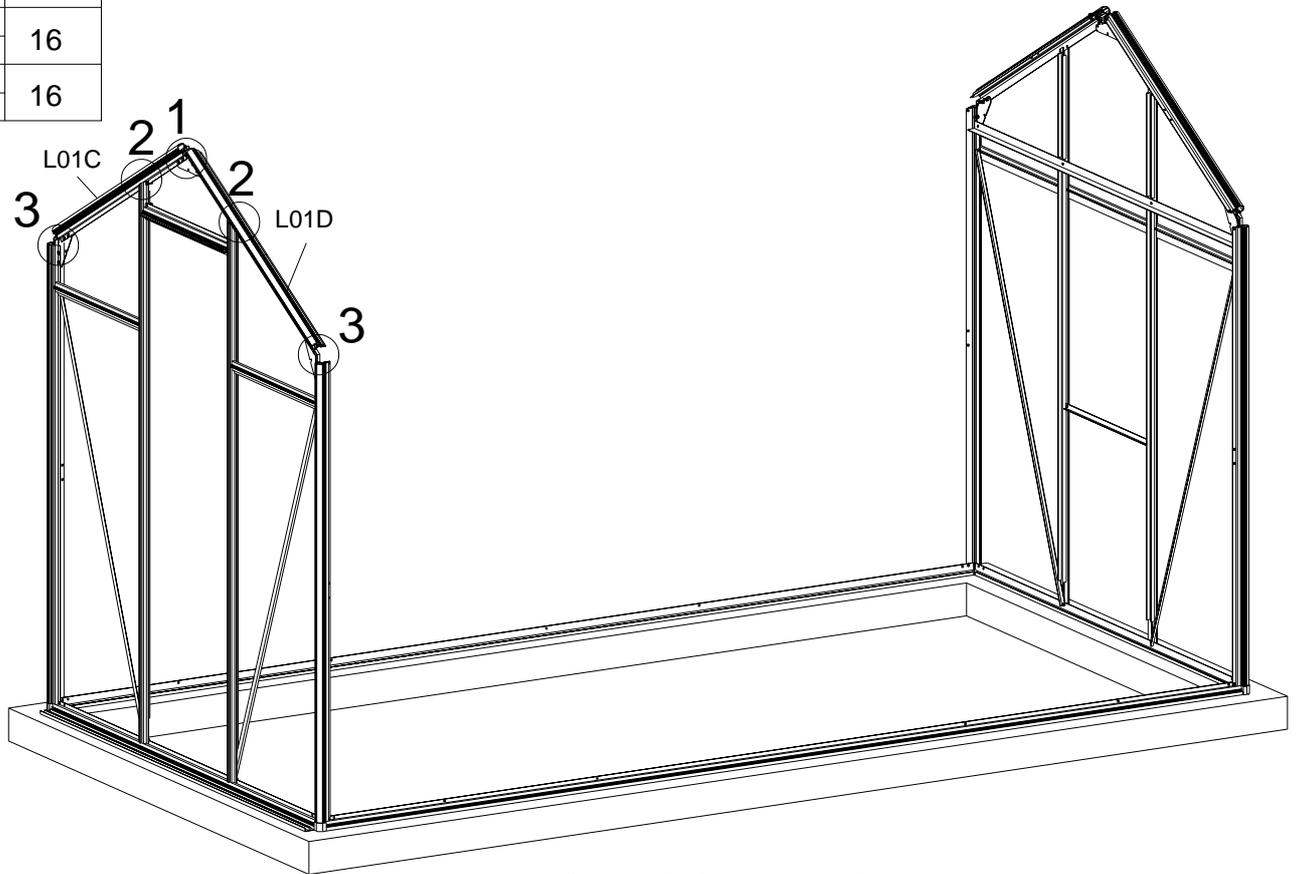
Schieben Sie den Verbinder A26 in L01C und L01D um sie zu verbinden. Verwenden Sie Teil D17 um alles mit den mitgelieferten Schrauben und Muttern zu befestigen.
