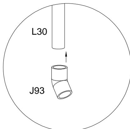
Wenn Sie undichte Stellen vermeiden wollen, verwenden Sie Kleber, um die Fallrohrbögen zu befestigen (nicht im Lieferumfang enthalten).
