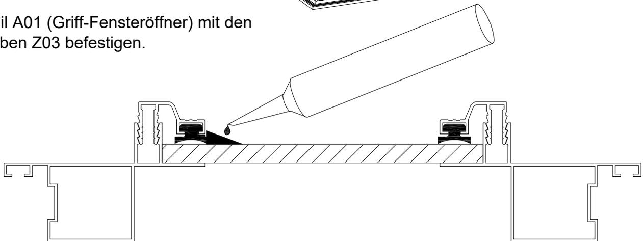
**HINWEIS:** Um Wasserlecks zu vermeiden, empfehlen wir, alle Fugen zwischen dem Rahmen und der Platte Y10 abzudichten.
