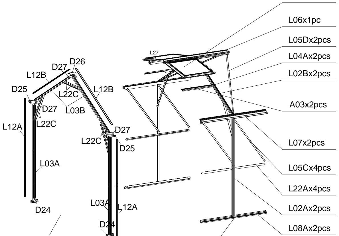
Montageanleitung für das Mittelteil (verbindet das Basispaket mit dem Erweiterungspaket).
