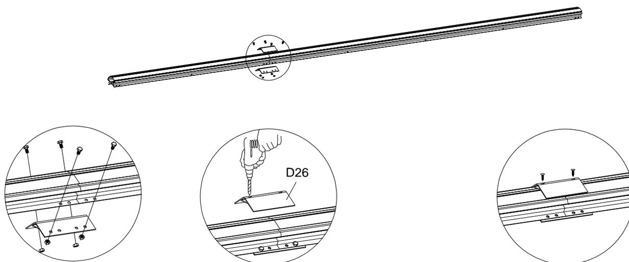
Montieren Sie L06B und L06 mit Hilfe der D27-Profile zusammen mit den Schrauben und Muttern.
