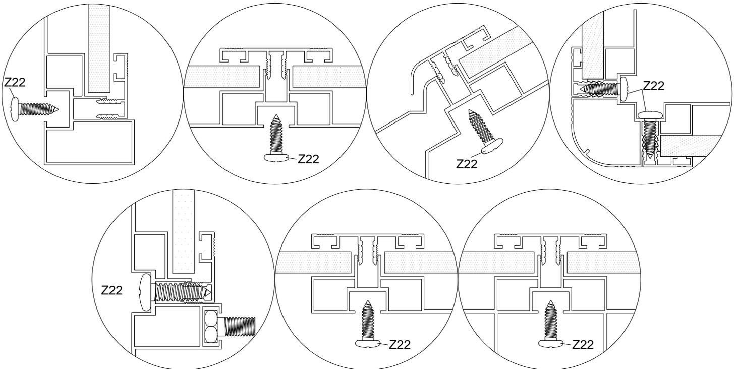
Befestigen Sie jedes Abdeckprofil fest mit den Schrauben Z22, wie in den Detailzeichnungen gezeigt.
