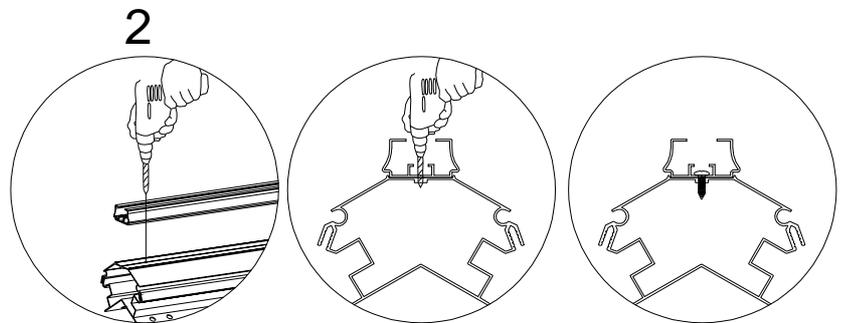
Schneiden Sie 56mm von 2 Profilen L26 (nahe D26) ab. Montieren Sie dann alle L26 auf L06B & L06 und achten Sie darauf, dass L26 mit den Längen von L06B & L06 übereinstimmt (siehe Abb. oben).
