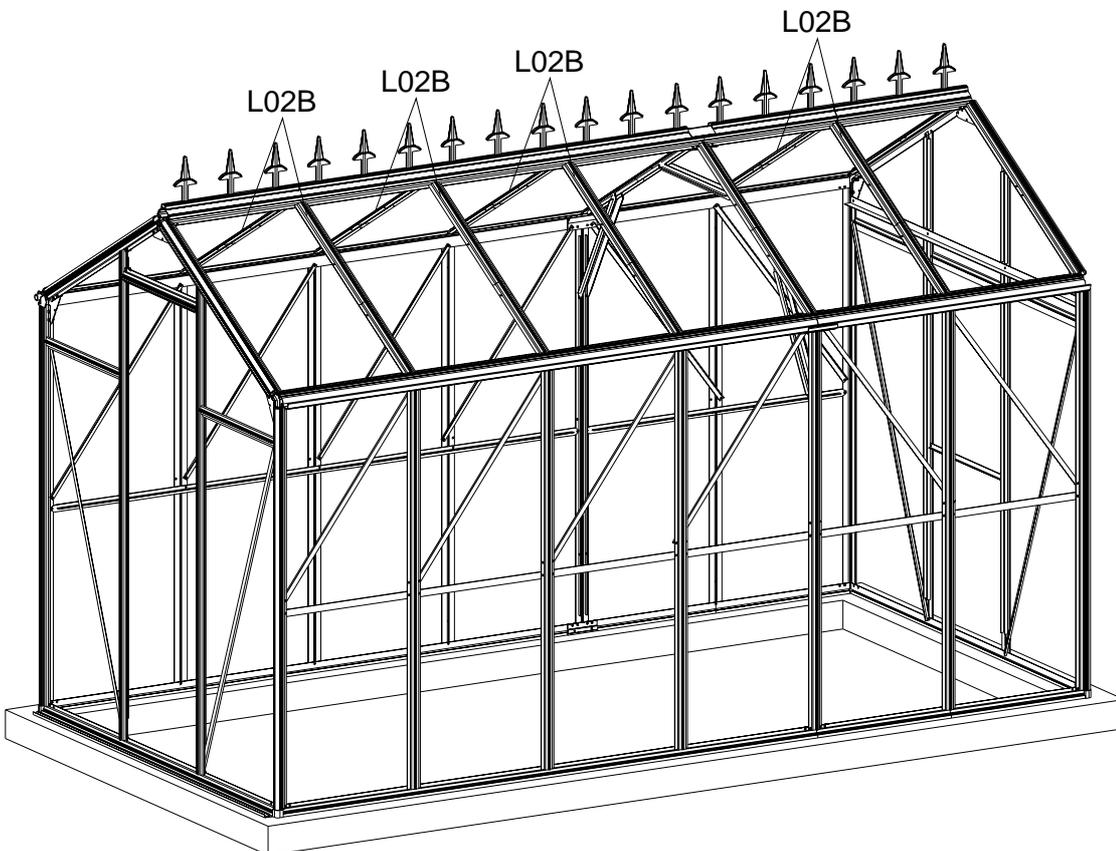
Montieren Sie L02B und achten Sie darauf, dass Sie 3 zusätzliche Schrauben in das Profil einsetzen, die später zur Befestigung der Verstärkung benötigt werden.
