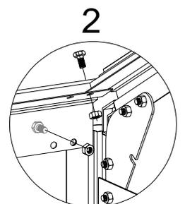
\* Bevor Sie das L22C montieren und die Schrauben und Muttern festziehen, drücken Sie von unten gegen den Dachfirst, um zu prüfen, ob der gesamte Dachfirst gerade ist.
